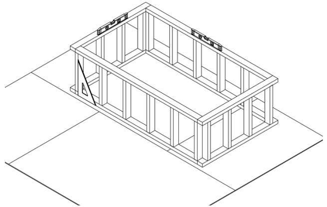
**Note** : Installer le bain sur un plancher au niveau et un podium bien à l'équerre. Si le plancher présente une pente, l'installateur doit effectuer les ajustements nécessaires pour garantir une installation au niveau et assurer le bon écoulement de l'eau.
