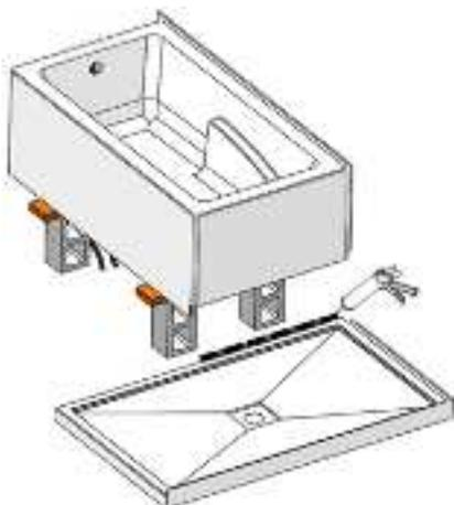
**6.** Retirer les blocs et déposer le bain à sa position finale, tout en raccordant le drain.
