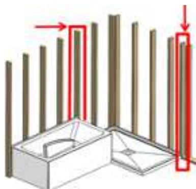
**8.** Sécuriser le bain en place à l'aide des vis pour cloison sèche, en les vissant aux colombages au-dessus de la bride du bain.
