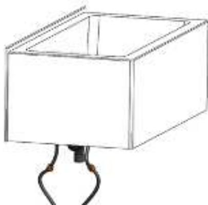
**4.** Installer le bain sur des blocs à l'endroit où il sera positionné. Faire les connections nécessaires (eau chaude/froide, lumière de chromathérapie, clavier, détecteur d'eau, souffleur). Le souffleur peut être relocalisé ailleurs que sous la jupe pour permettre un accès facile.
