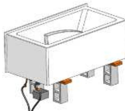
**5.** Appliquer un généreux trait de silicone sur le côté de la base où il y a contact avec le bain (le long de la bride).
